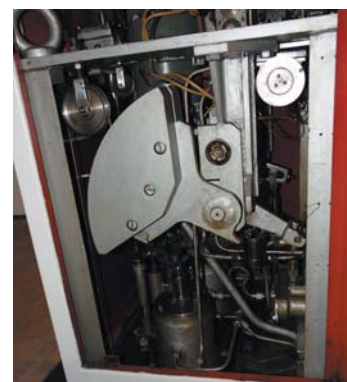
Было: регуляторы скорости ЭГРК-100, производство «ЛМЗ».
